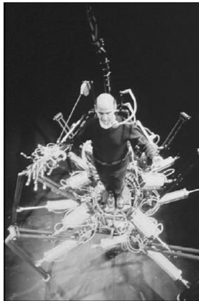
**Figura 5.3:** Uma forma extrema de corpamento alternativo! O exoesqueleto é uma máquina irregular, formada por 600kg de juntas rígidas, que utiliza dezoito atuadores pneumáticos para conduzir os três degraus de pernas
